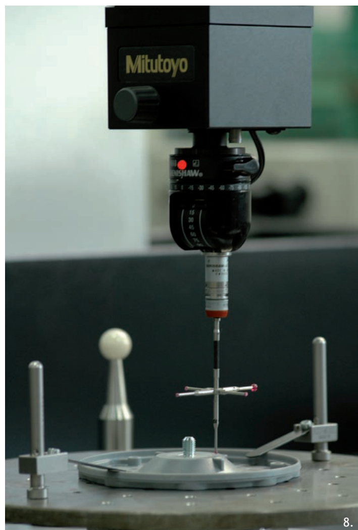
8. Controllo dimensionale con CMM.
